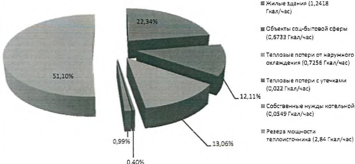
расчётной температуре воздуха расчётная присоединённая тепловая нагрузка в размере 2,84 Гкал/час должна покрываться установленной мощностью двух рабочих котлов по 1,5 Гкал/час каждый. На расчётный срок строительства резерв мощности сократится до 1,51 Гкал/час. В работе необходимо держать три котла КВм-1,8 при расчётной температуре воздуха.
