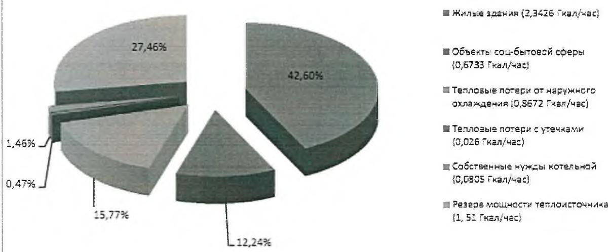
Существующий резерв установленной мощности на котельной №3 - 59,46%. При расчётной температуре воздуха расчётная присоединённая тепловая нагрузка в размере 0,58 Гкал/час должна покрываться установленной мощностью котла КВм-1,25. На расчётный срок строительства возникнет дефицит установленной мощности 0,5 Гкал/час.
