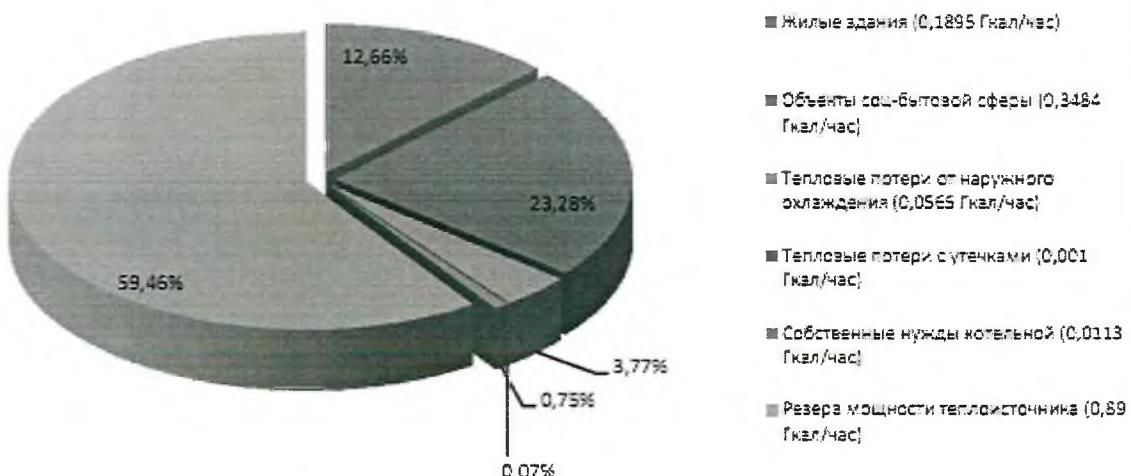
Резерв установленной мощности на котельной №6 - 77,2%. При расчётной
